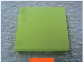
波長変換石英ガラス(2mm厚)
