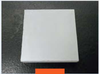
波長変換石英ガラス(2mm厚)
